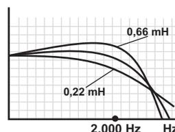
Wird der Spulenwert verkleinert, steigt der Pegel im oberen Bereich. Falls der Präsenzbereich zu laut ist, kann durch Vergrößern des Spulenwerts der Pegel gesenkt werden.
