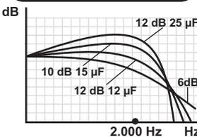
Aktivieren durch Umstecken der Goldbrücke vom rechten 6/12 dB in den linken 0 dB Bereich. Damit wird der Mitteltöner nicht nach oben begrenzt. Vorteil ist, dass keine Bauteile geschaltet sind, die eine Dämpfung bewirken würden. Somit ist der beste Wirkungsgrad erreichbar.
