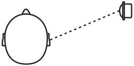
Werden Hochtöner direkt strahlend (mit geringem Fehlwinkel) eingebaut, sind sie im Superhochtonbereich (nur im oberen Hochtonbereich) teilweise zu laut.
